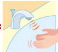
センサーが感知して適量を吐水、遠ざければ止水。水のムダ遣いをストップ。
