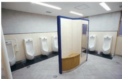
宝塚市立御殿山小学校の男子トイレは、隣り合っていた男女のトイレを一体化し、大きく空いた中央部に鏡とベンチを組み合わせたスクリーンを設置して回遊動線をつくり、あわせて大便ブースとを視覚的に分離している。
